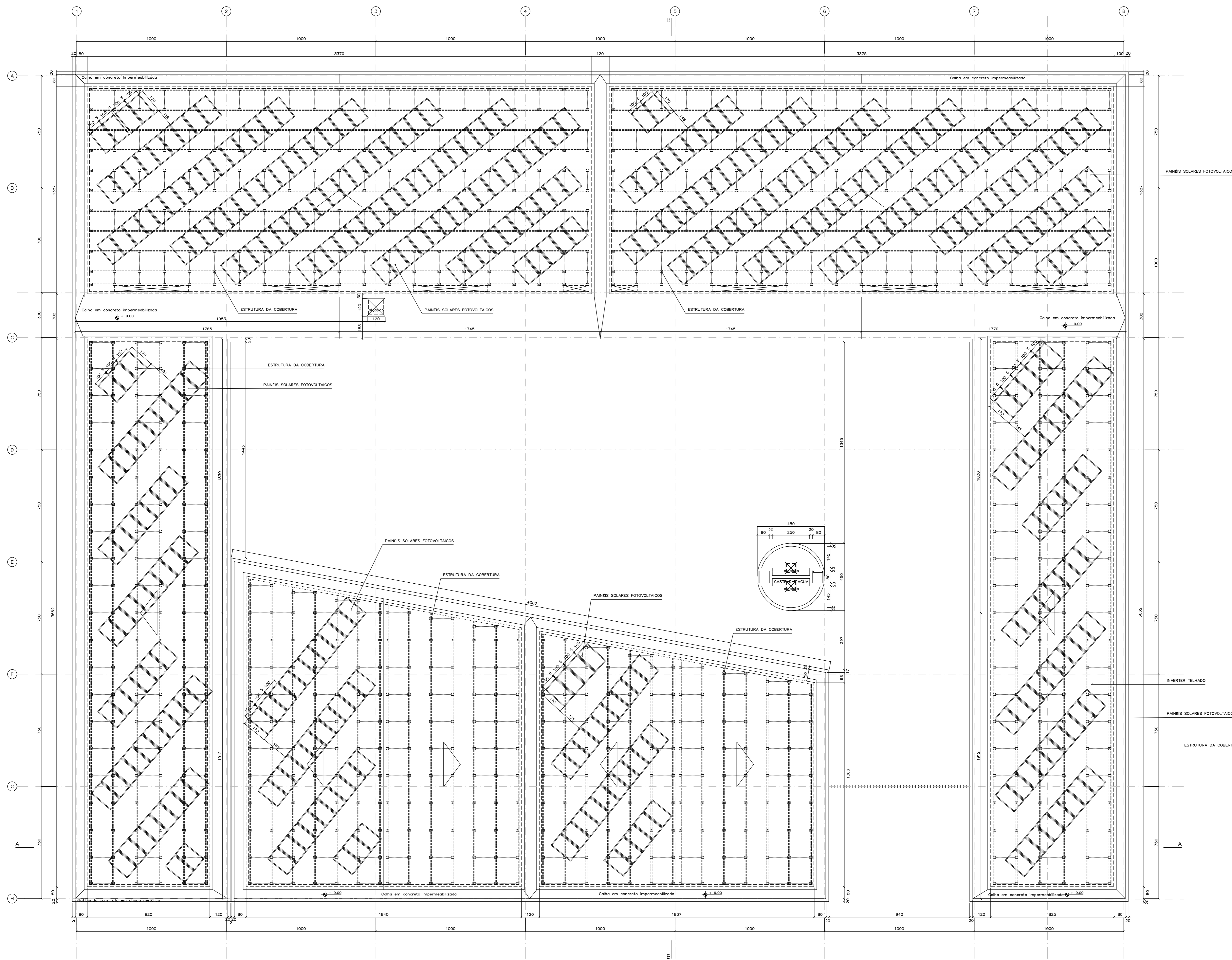
LAYOUT DAS PLACAS FOTOVOLTAICAS PLANTA BAIXA ESC.: 1:100
