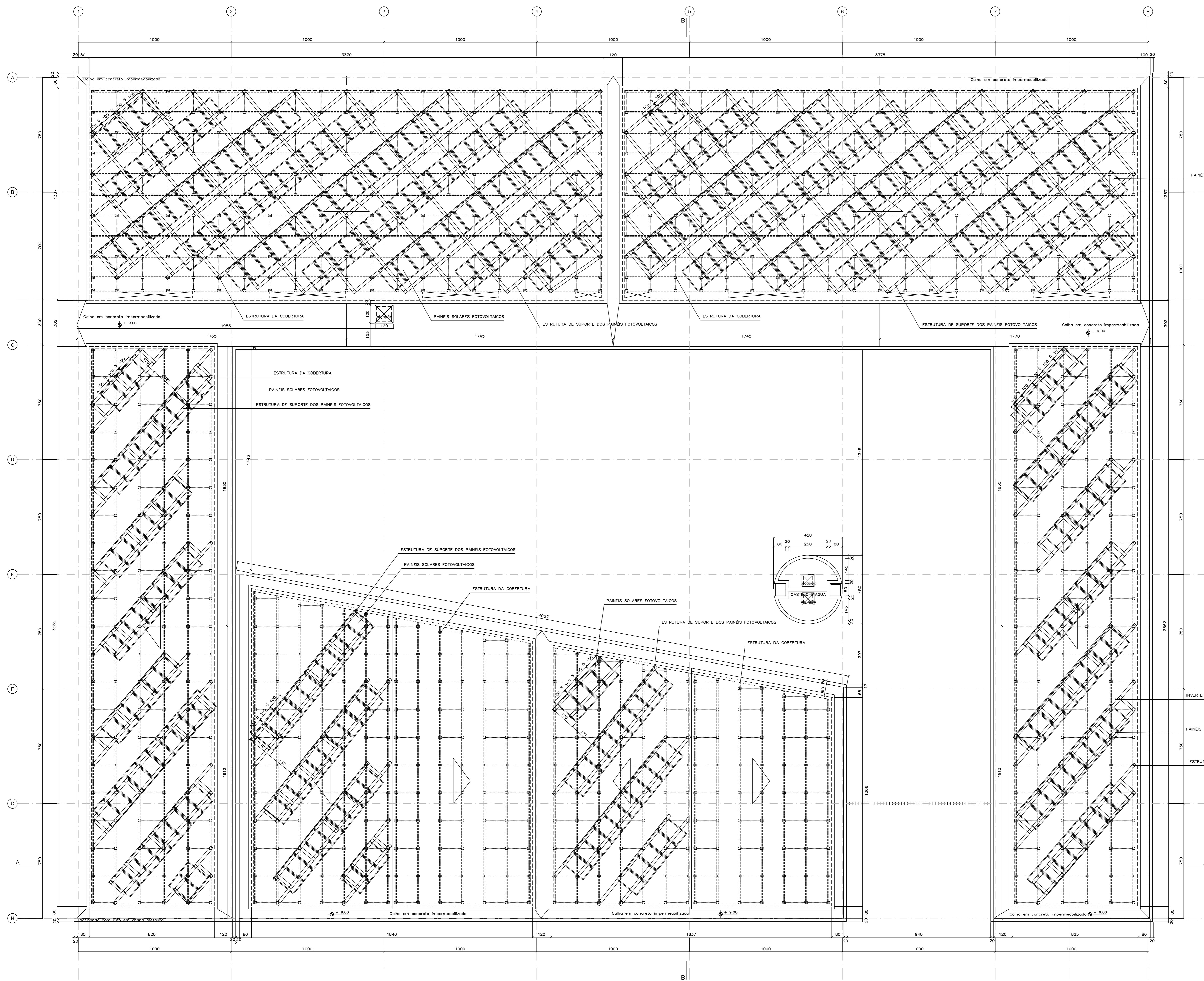
ESTRUTURA METÁLICA PARA INSTALAÇÃO DAS PLACAS FOTOVOLTAICAS PLANTA BAIXA ESC.: 1/100
