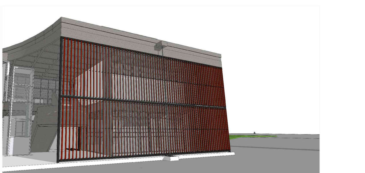
IMAGEM 06: fachada Noroeste com brises verticais junto às janelas do térreo e 1º pavimento (ocupação sala da direção no térreo)
