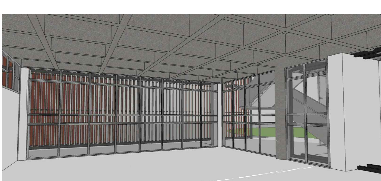
IMAGEM 08: vista interna do térreo-salas da direção- DIA 24 junho às 16h, com brises verticais; os brises propostos se mostraram eficiente no controle solar
