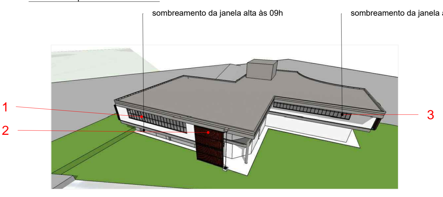
IMAGEM 02: fachada Sudeste - DIA 22 dezembro às 09h - pouca incidência solar - sombreamento pela marquise de parte das esquadrias
