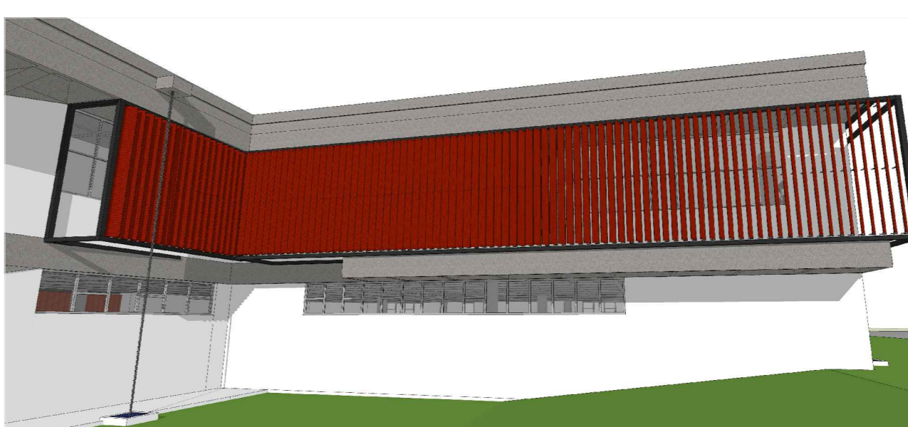
IMAGEM 03: fachada Noroeste com brises verticais junto às janelas do 1º pavimento (ocupação com salas administrativas)
