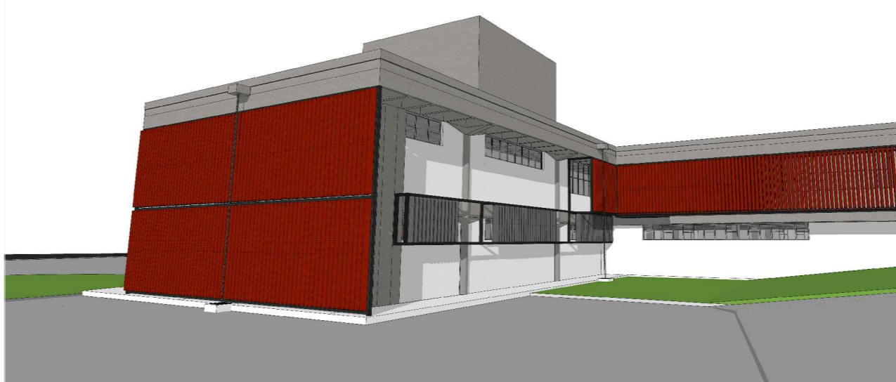
IMAGEM 02: fachada Noroeste com brises verticais - DIA 24 junho às 16h. brise vertical em painel perfurado em alumínio extrudado 300mm de largura, referência aeroscreen hunter douglas - cor Naranja escuro 4557 e Alumínio Médio 7257.
