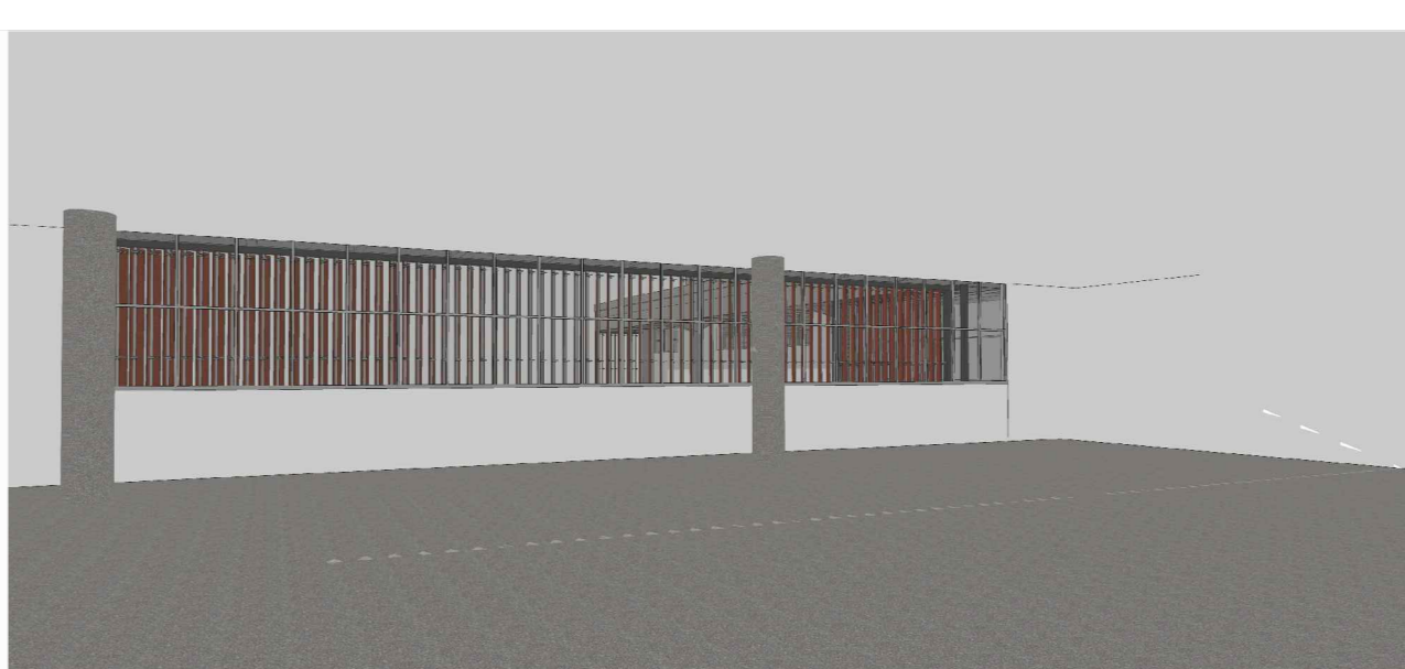
IMAGEM 05: vista interna do 1º pavimento -salas administrativas - DIA 24 junho às 16h, com brise. os brises propostos se mostraram eficiente no controle solar
