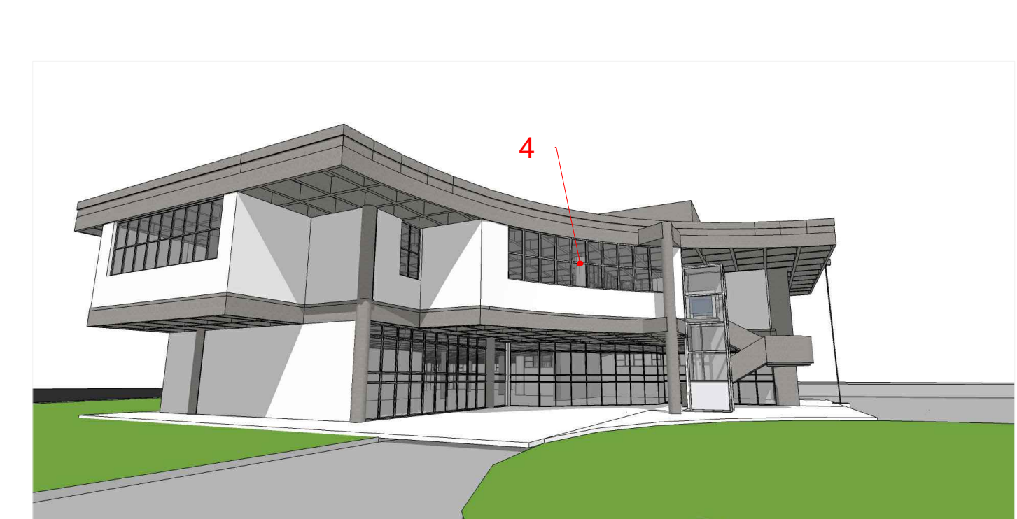
IMAGEM 01: fachada Norte existente - DIA 22 junho às 11h - os ambientes de hall e recepção sofrem incidência solar - recomenda-se a proteção das aberturas a partir das 11h
