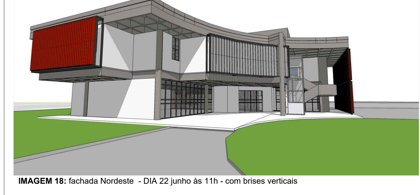
IMAGEM 18: fachada Nordeste - DIA 22 junho às 11h - com brises verticais
