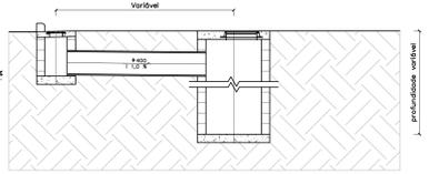
LIGAÇÃO ENTRE OS PV'S 5 A 10 E AS RESPECTIVAS BOCAS DE LOBO. DISTÂNCIA ENTRE EQUIPAMENTOS CONFORME LOCALIZAÇÃO. PROFUNDIDADE DOS POÇOS CONFORME PERFIL DO TERRENO.
