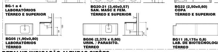
**DETALHE INDICAÇÃO ALTURAS SIFÕES SEM ESCALA**
