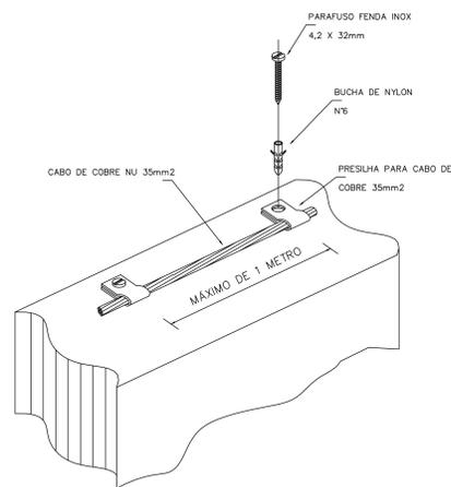
**DETALHE DA FIXAÇÃO DO CABO NA ALVENARIA/LAJE**
