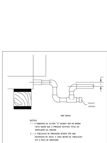
INSTALAÇÃO DE DRENO SEM ESCALA
