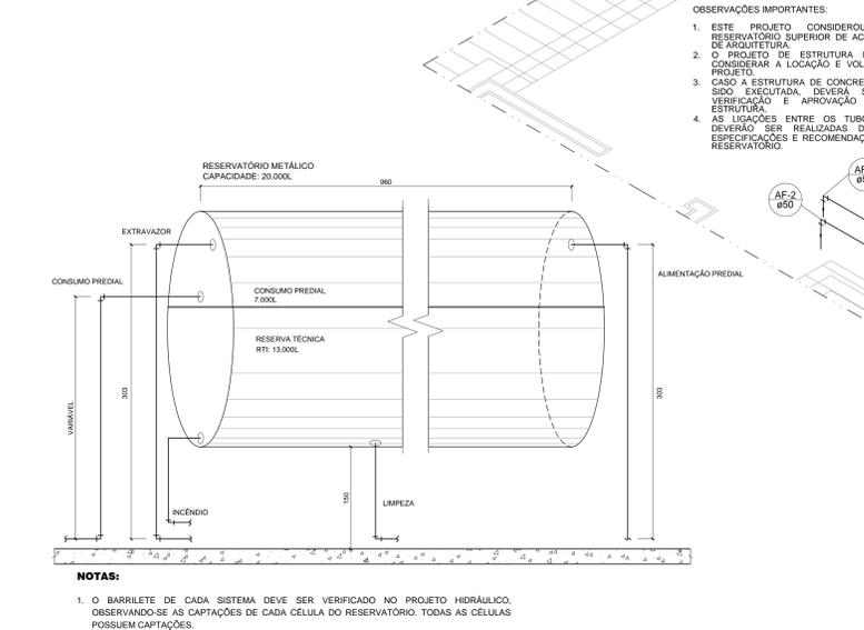
**ESQUEMA - RESERVATÓRIO - ALTURAS PARA CAPTAÇÃO**
