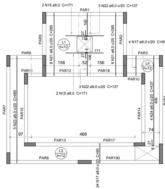
**ARMAÇÃO POSITIVA LAJES PAV. TÉRREO (EIXO Y)**
