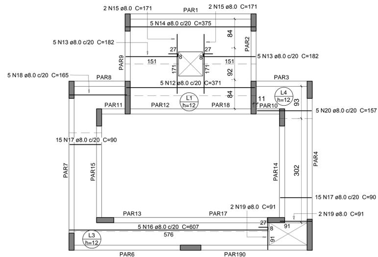
**ARMAÇÃO POSITIVA LAJES PAV. TÉRREO (EIXO X)**
