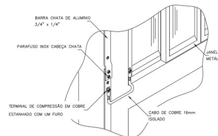
**DETALHE DE CONEXÃO DAS JANELAS COM AS DESCIDAS**
