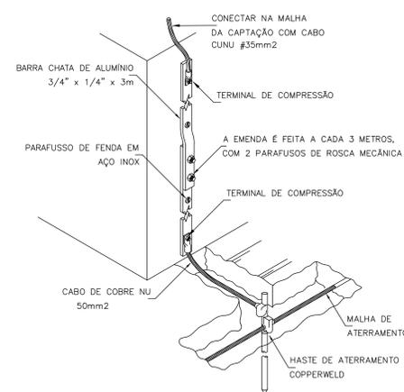
**CONEXÃO DA DESCIDA EM BARRA CHATA DE ALUMÍNIO COM O ATERRAMENTO**
