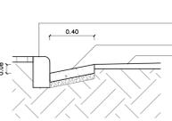
A INCLINAÇÃO NA SARRJETA SERÁ DE 20% E DEVERÁ SER GARANTIDA UMA LAMINA D'ÁGUA DE 8 CM ENTRE A GUA DO MEIO FIO E A PAVIMENTAÇÃO.
