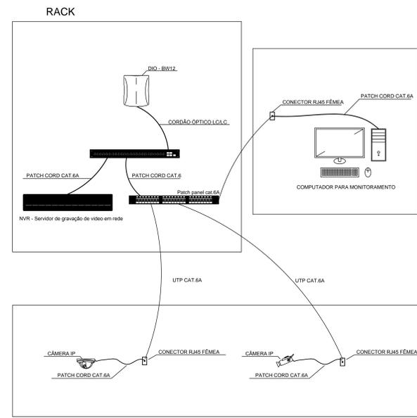
DETALHE ESQUEMÁTICO DO SISTEMA PARA LIGAÇÃO DAS CÂMERAS IP
