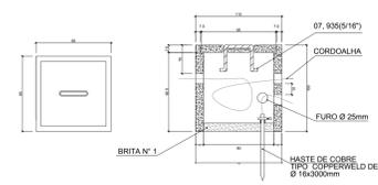
**DET. CAIXA DE PASSAGEM COM ATERRAMENTO SEM ESCALA**
