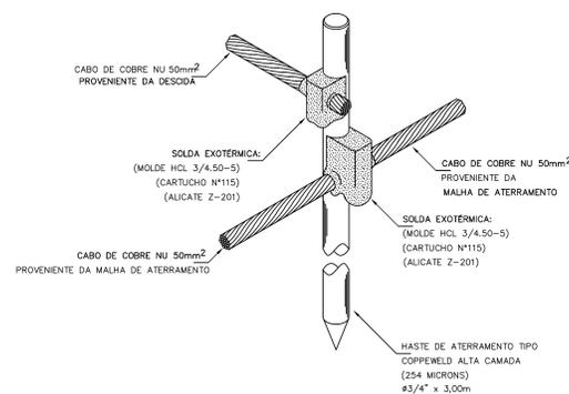
**DETALHE DE CONEXÃO DO CABO DE COBRE À HASTE DE ATERRAMENTO**
