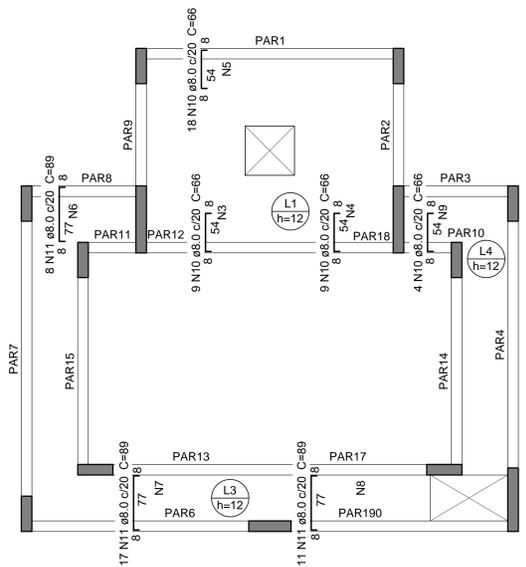
**ARMAÇÃO NEGATIVA LAJES PAV. TÉRREO (EIXO Y)**
