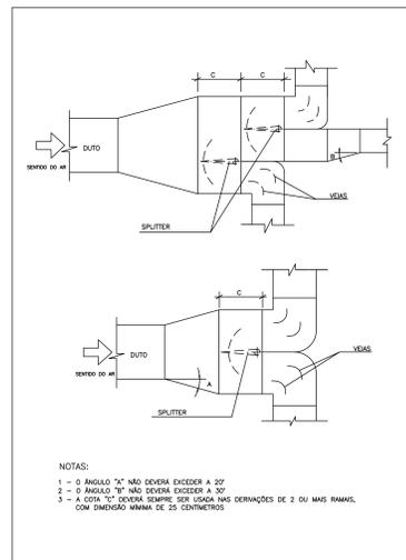
DETALHE DE CONSTRUÇÃO E MONTAGEM DE DUTOS SEM ESCALA
