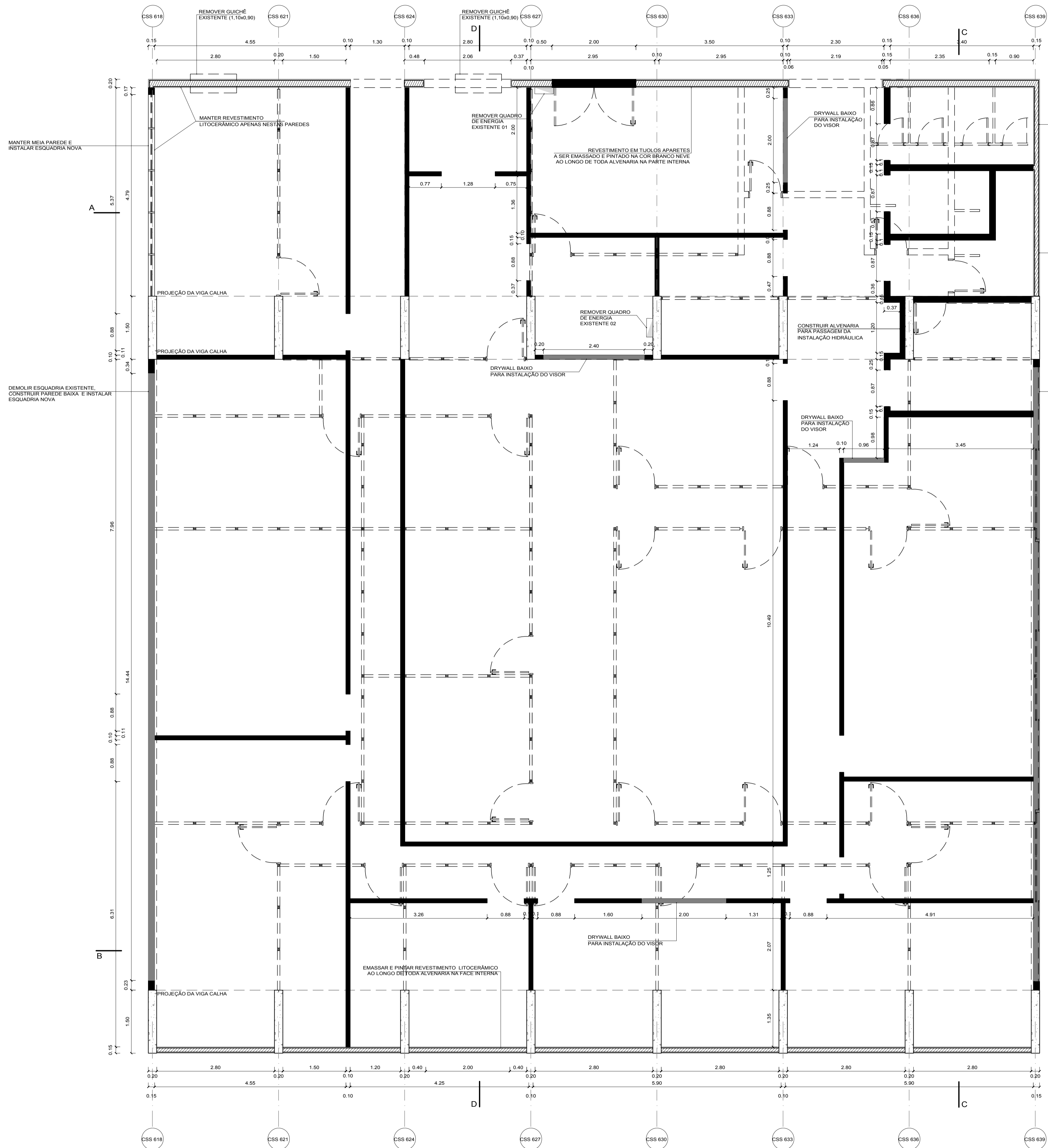
PLANTA BAIXA DEMOLIR / CONSTRUIR ICC - SUBSOLO ESC: 1:50
