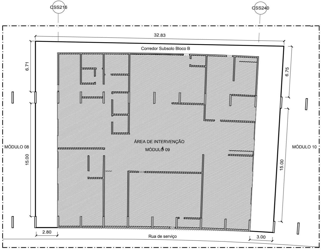
LOCAÇÃO DE TAPUME MÓDULO 09 ESC.: 1:250
