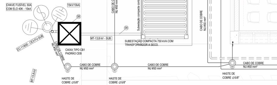
NOTA: INSTALAR CABOS DE COBRE NU #50 mm² ENTERRADOS NO SOLO COM ALTURA MÍNIMA DE 600 mm
