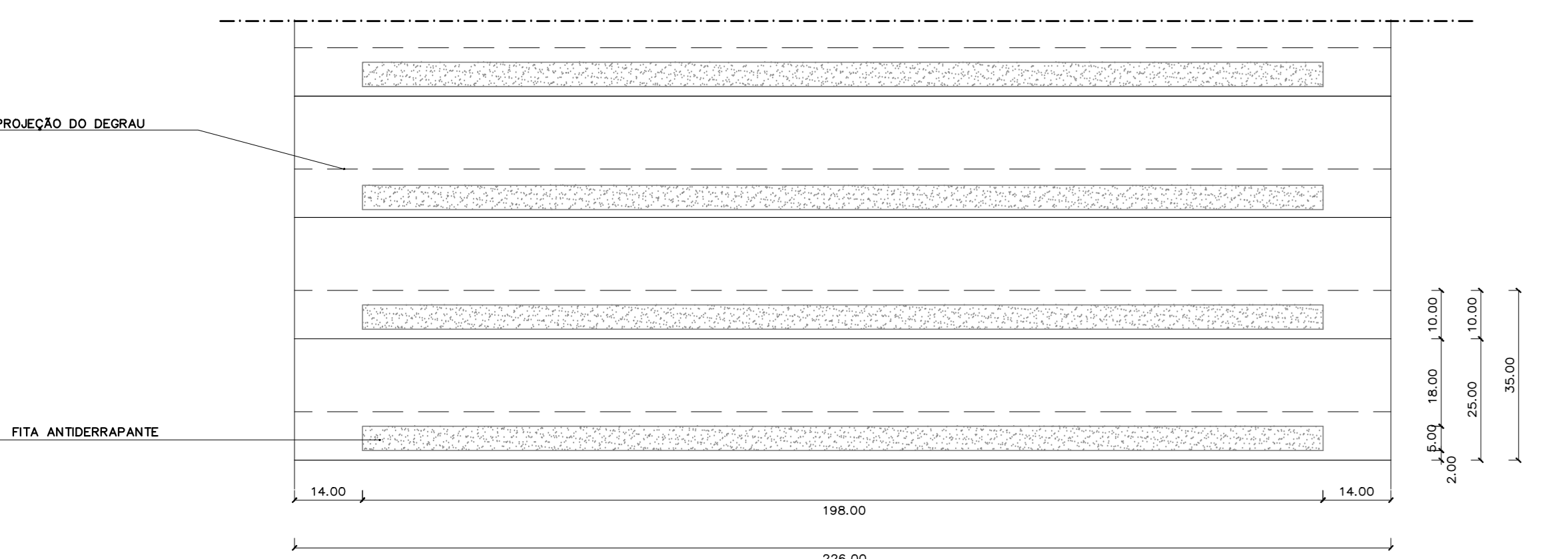
DET 01 FITAS ANTIDERRAPANTES NOS DEGRAUS ESC: 1:10
