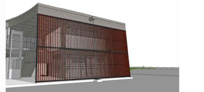
IMAGEM 06: fachada Noroeste com brises verticais junto às janelas do térreo e 1º pavimento (ocupação sala da direção no térreo)
