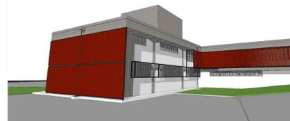
IMAGEM 02: fachada Noroeste com brises verticais - DIA 24 junho às 16h. brise vertical em painel perfurado em alumínio extrudado 300mm de largura, referência aeroscreen hunter douglas - cor Naranja escuro 4557 e Alumínio Médio 7257.
