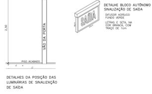
1 DETALHES GERAIS - SINALIZAÇÃO E ILUMINAÇÃO DE EMERGÊNCIA SEM ESCALA
