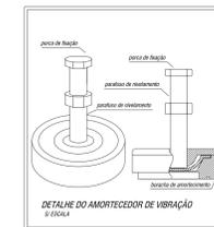
DETALHE TÍPICO DE INSTALAÇÃO DO AMORTECEDOR DE VIBRAÇÃO
