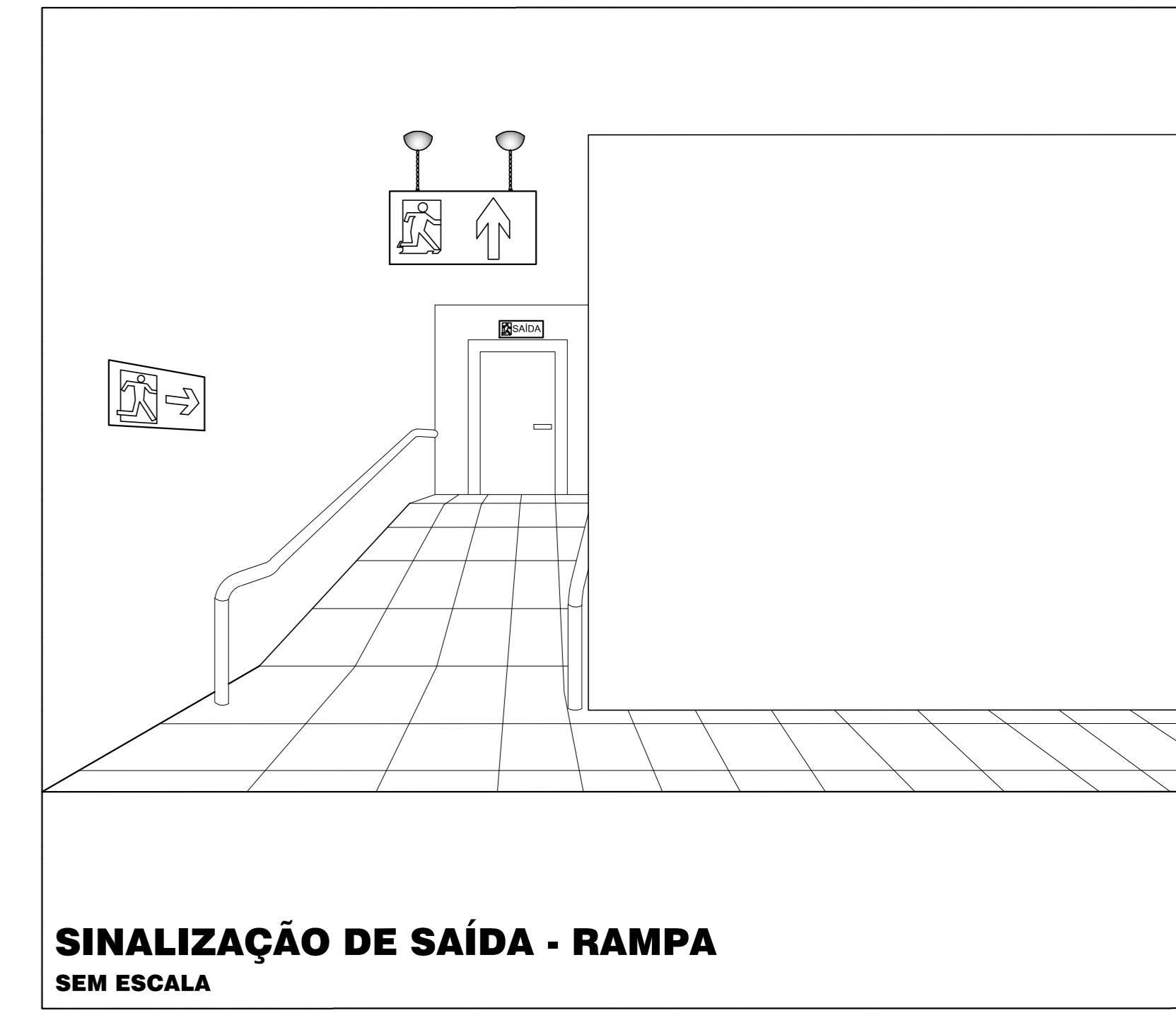
SINALIZAÇÃO DE SAÍDA - RAMPA SEM ESCALA
