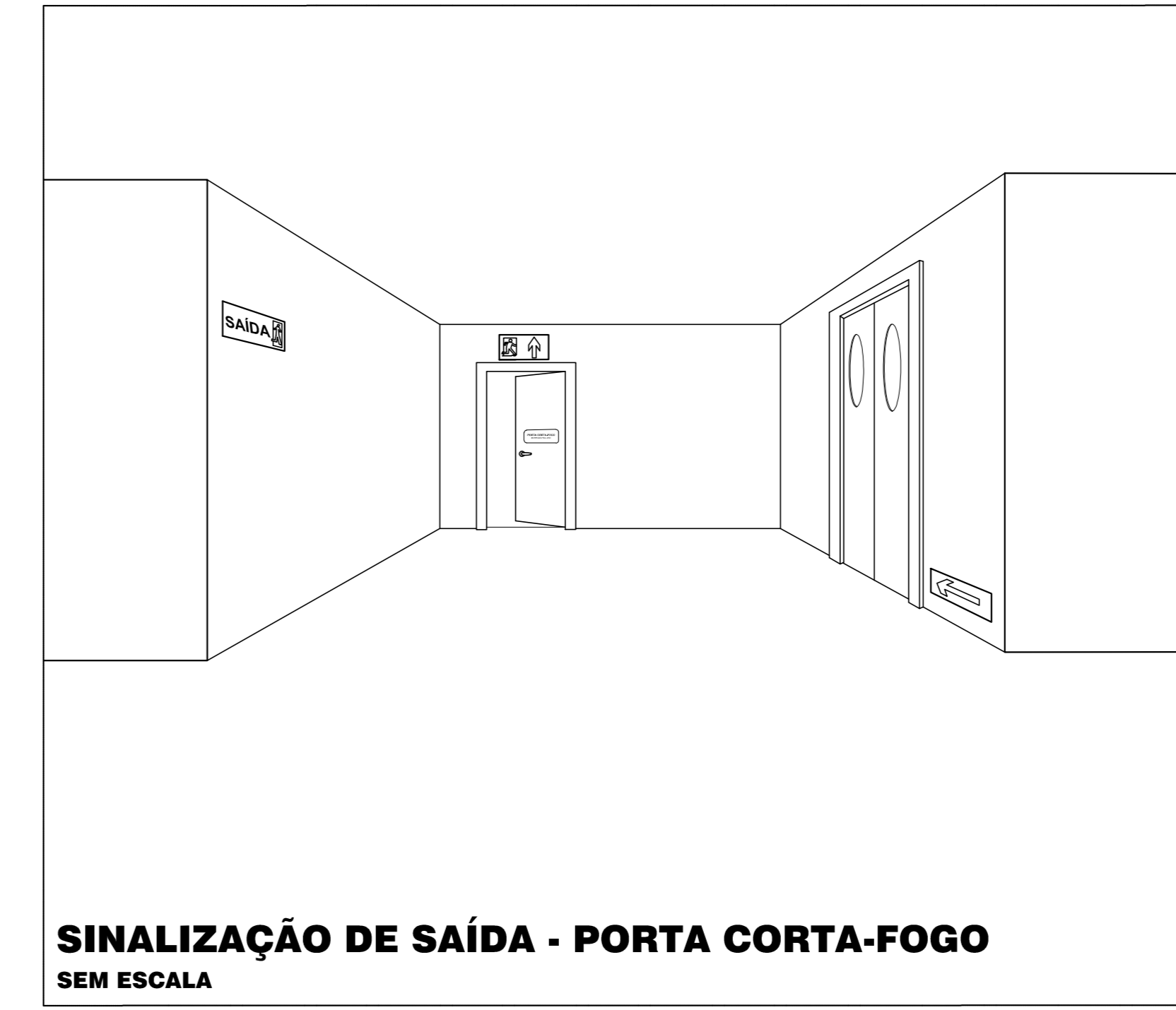
SINALIZAÇÃO DE SAÍDA - PORTA CORTA-FOGO SEM ESCALA
