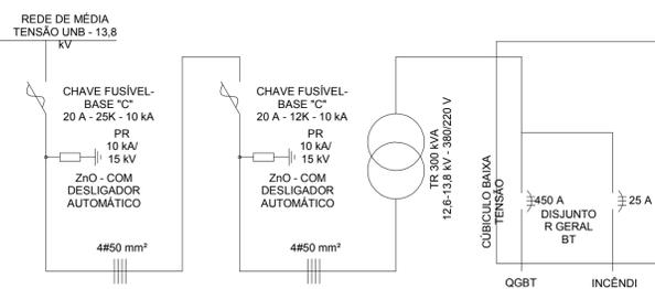
**3** Diagrama Unifilar - Subestação
