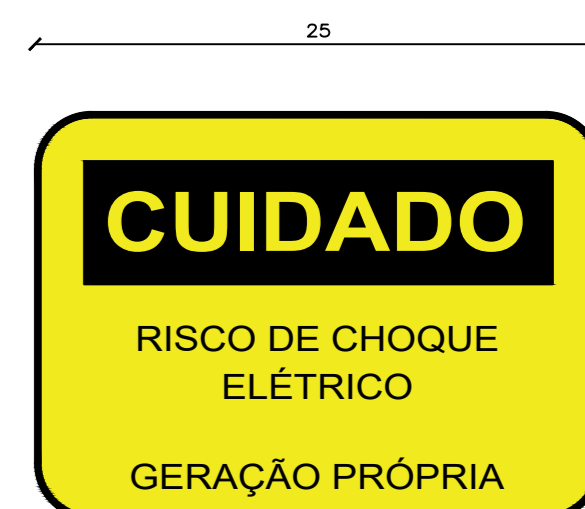
PLACA DE ADVERTÊNCIA VISTA FRONTAL SEM ESC.
