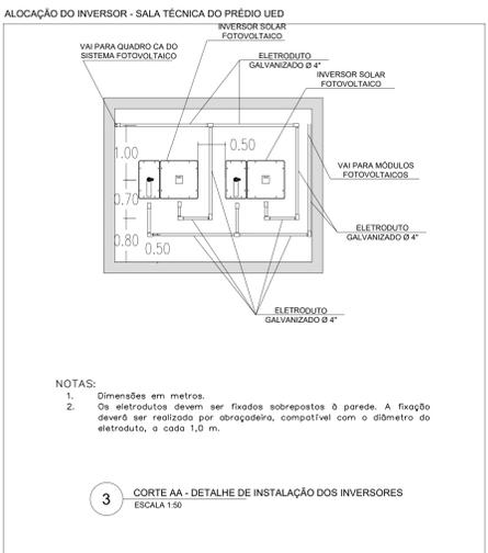
3 CORTE AA - DETALHE DE INSTALAÇÃO DOS INVERSORES ESCALA 1:50
