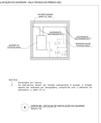
4 CORTE BB - DETALHE DE INSTALAÇÃO DO QUADRO ESCALA 1:50
