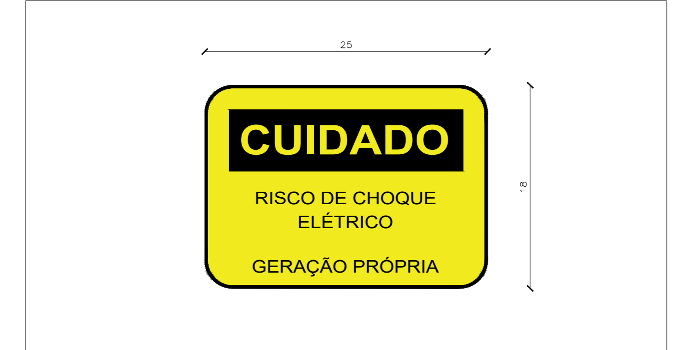
PLACA DE ADVERTÊNCIA VISTA FRONTAL SEM ESC.
