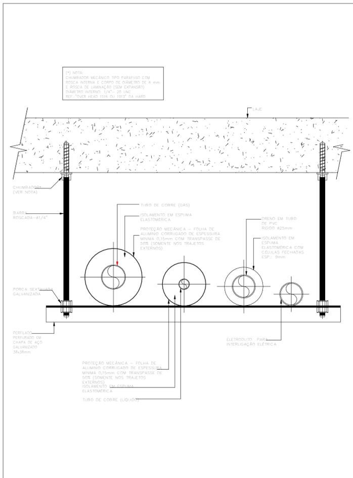
DETALHE TÍPICO - FIXAÇÃO DE TUBULAÇÕES, DRENO E DE INTERLIGAÇÕES ELÉTRICAS NA LAJE
