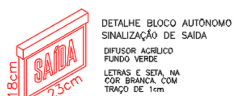
DETALHE BLOCO AUTÔNOMO SIGNALIZAÇÃO DE SAÍDA
