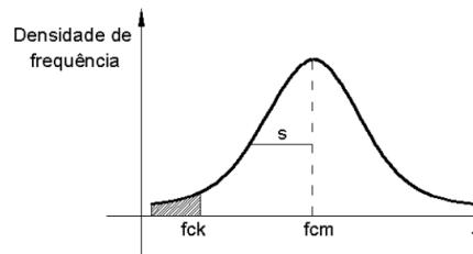
Curva de Gauss para a resistência do concreto à compressão
