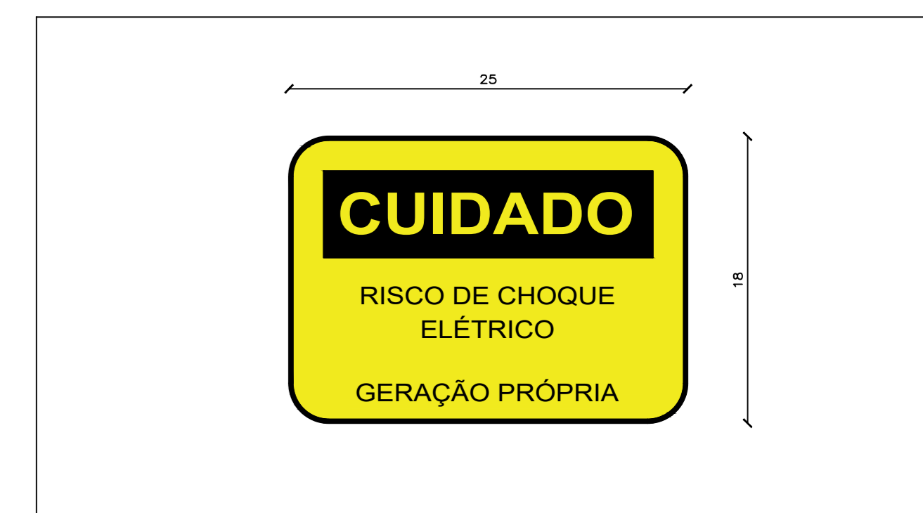
PLACA DE ADVERTÊNCIA VISTA FRONTAL SEM ESC.
