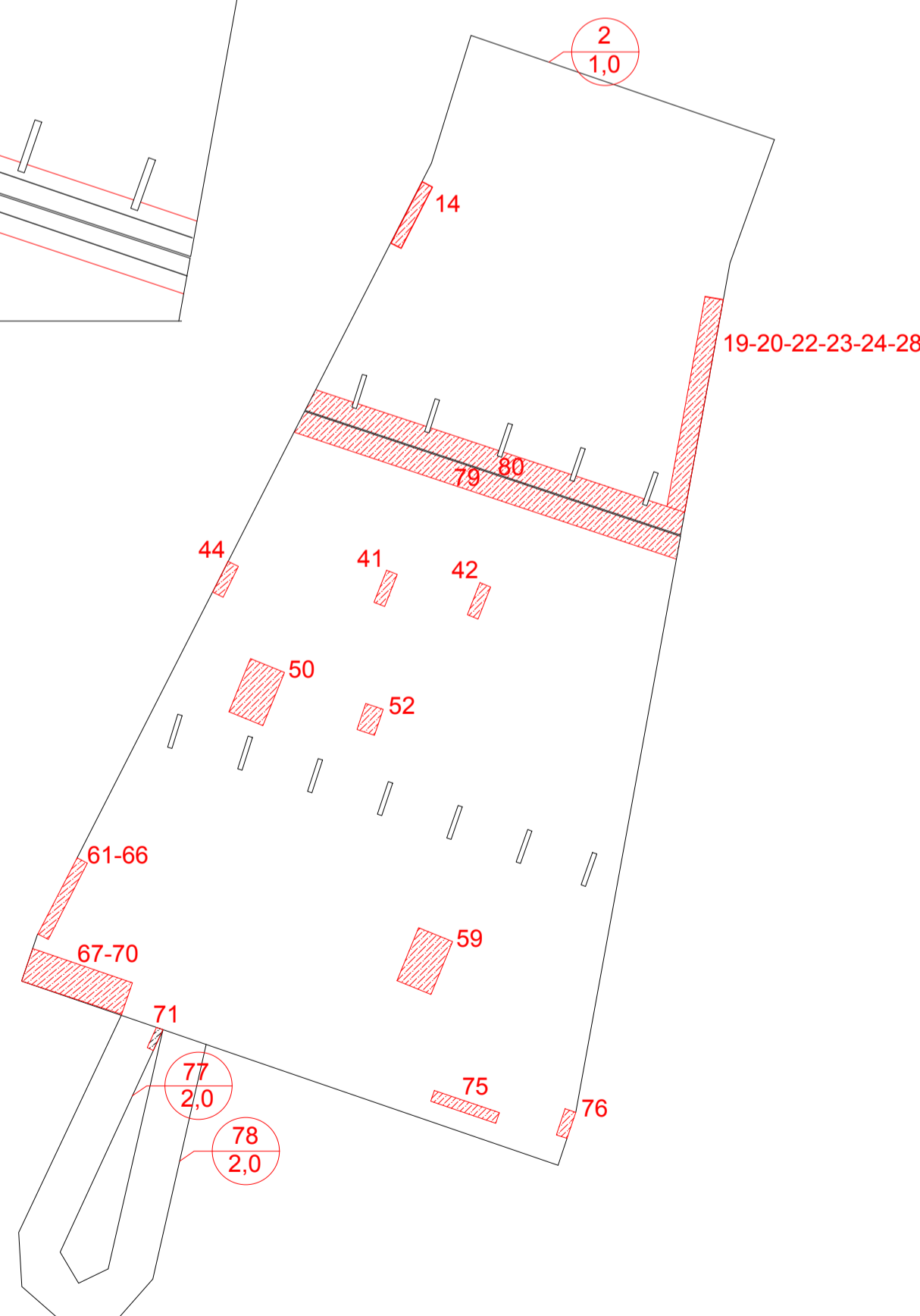
TRATAMENTO SUPERFICIAL FACE INFERIOR DA LAJE E LATERAL DA RAMPA
